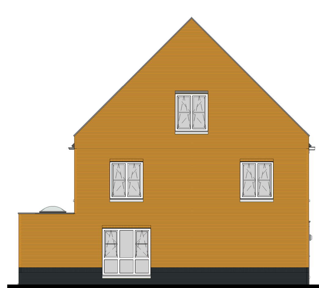
Zijgevel Optie uitbouw achtergevel 2,4 meter Optie lichtkoepel in plat dak 1000 x 1000 mm Optie extra kozijn zolderverdieping 1:100
