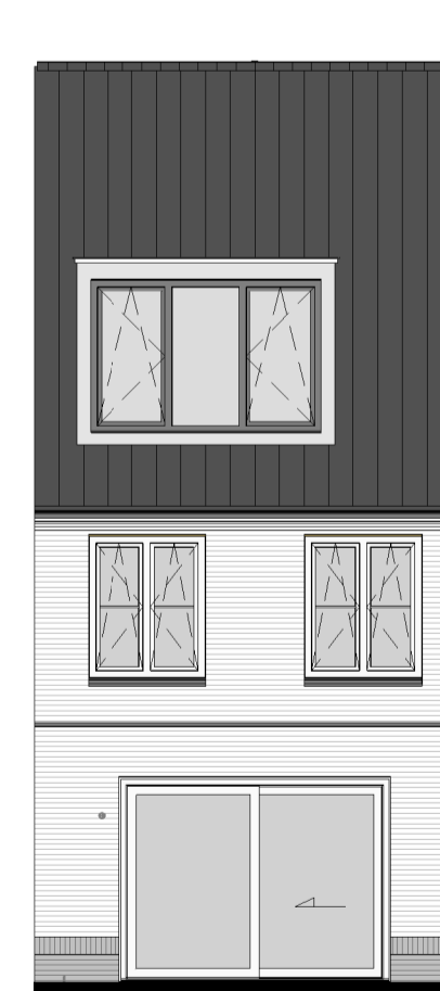
Achtergevel Optie uitbouw achtergevel Optie kunststof schuifpui Optie dakkapel achterzijde 2800 mm. breed 1:100
