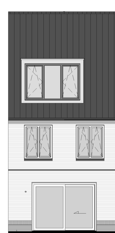
Achtergevel Optie uitbouw achtergevel Optie kunststof schuifpui Optie dakkapel achterzijde 2800 mm. breed 1:100
