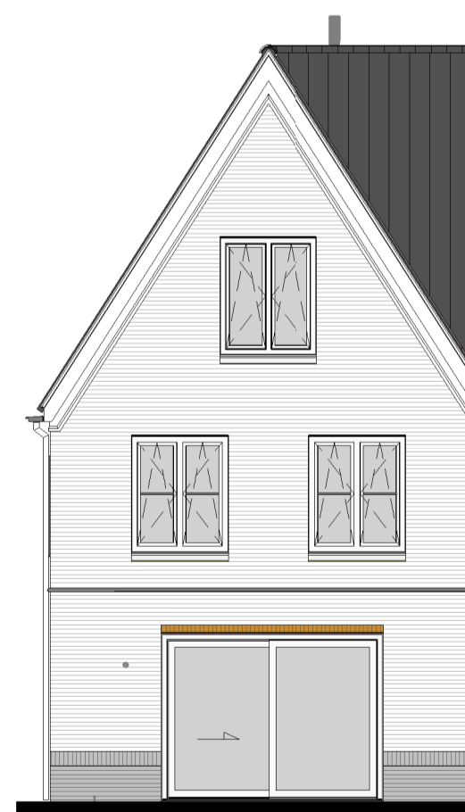
Achtergevel Optie uitbouw achtergevel Optie kunststof schuifpui 1:100
