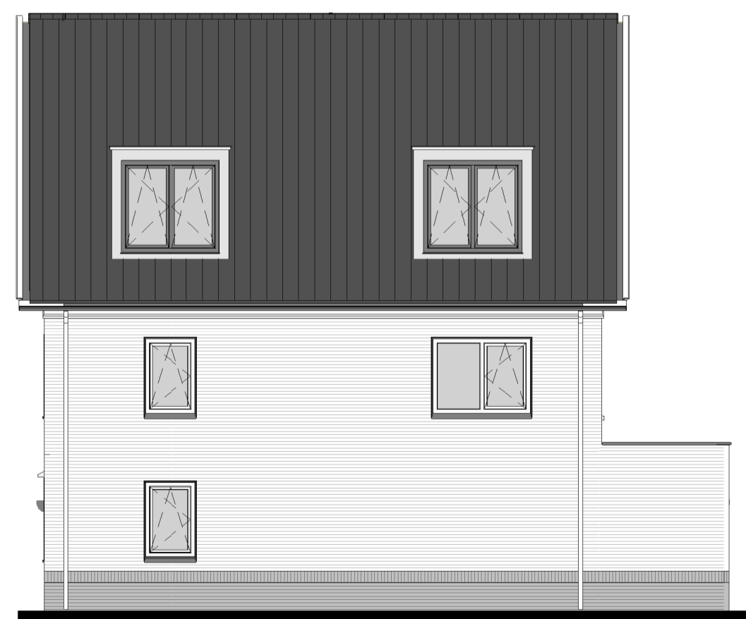
Zijgevel Optie uitbouw achtergevel 2,4 meter Optie dakkapel zijzijde (voor) 1850 mm. breed Optie dakkapel zijzijde (achter) 1850 mm. breed 1:100
