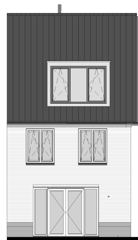
Achtergevel Optie dakkepel achterzijde 2800 mm. breed 1:100
