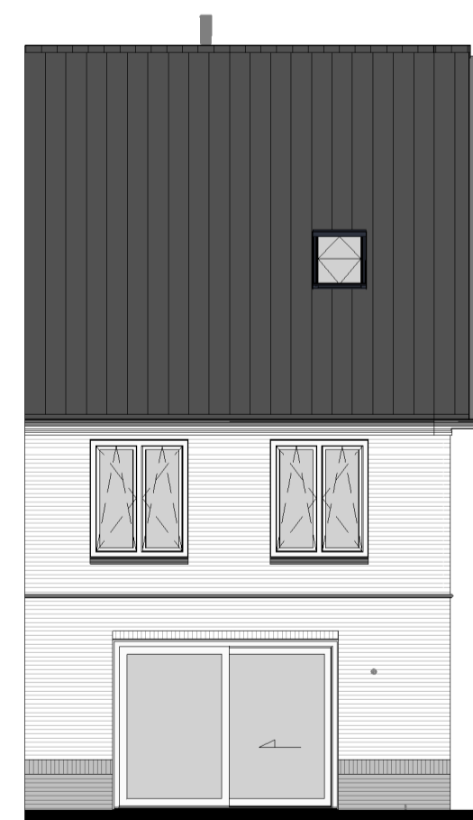
Achtergevel Optie uitbouw achtergevel Optie kunststof schuifpui 1:100
