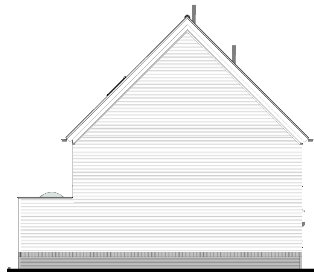
Zijgevel Optie uitbouw achtergevel 2,4 meter Optie lichtkoepel in plat dak 1000 x 1000 mm 1:100
