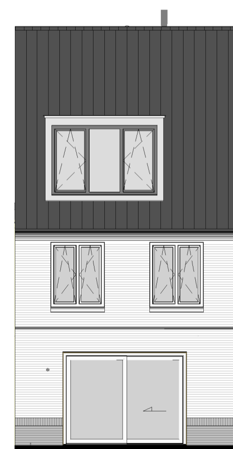
Achtergevel Optie uitbouw achtergevel Optie kunststof schuifpui Optie dakkapel achterzijde 2800 mm. breed 1:100
