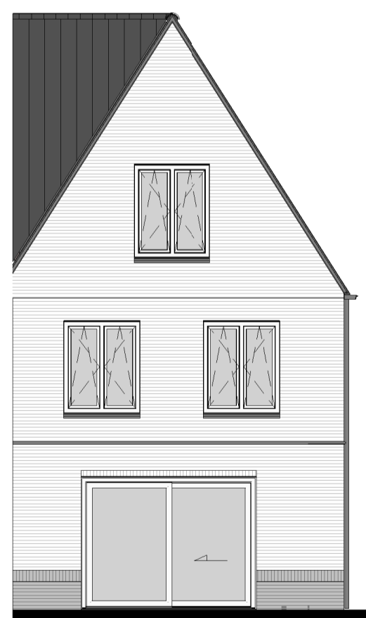
Achtergevel Optie uitbouw achtergevel Optie kunststof schuifpui 1:100
